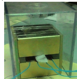
Рис. 5. Измерительная ячейка с интеркалированным образцом под воздействием магнитного поля. Величина магнитной индукции составляет B = 660 мТл.
