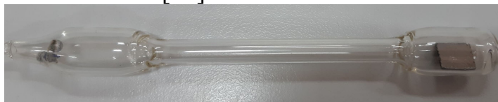
Рис. 1. Ампула «реактора» для проведения двухзонной интеркаляции. На левой стороне находится калий, в правой ВОПГ.
