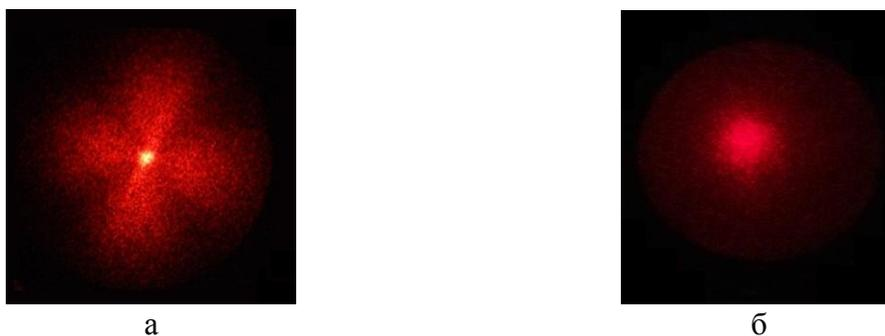
Рис. 3. Снимки наблюдаемой структуры пленок ПВДФ, полученных методами кристаллизации из расплава (а) и кристаллизации из раствора (б).
